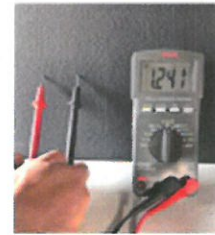
壁に電位が発生している。
