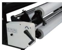
繰り出し側に汎用メディアを3本までセットでき、ハンドルを廻せば簡単にメディアの切替が可能です。省スペース化・小作業化により、おひとりでの作業でも安全で効率よくお使いいただけます。
